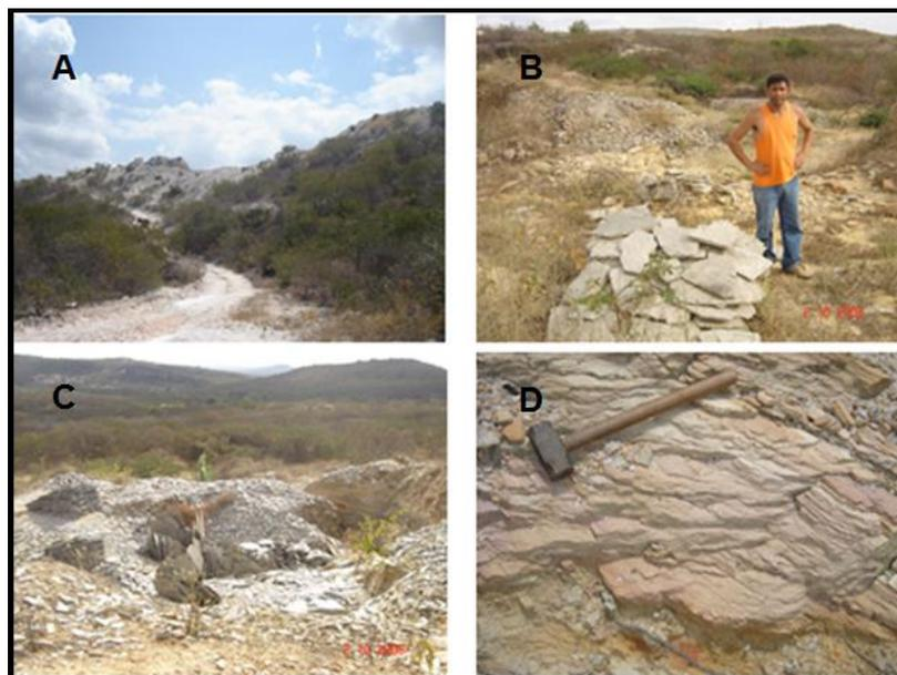
**Figura 8** – Quatro garimpos de quartzitos. Disposição inadequada do rejeito (A); pequenas placas de quartzito (B) e (C); fraturamentos ortogonais nos quartzítos.
