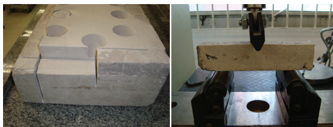
Figura 5: a) Corte do revestimento para extração de prismas para ensaios mecânicos e b) ensaio de tração na flexão em prisma extraído do revestimento.
