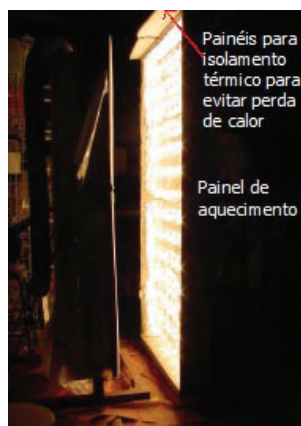
Figura 3: Painel para aquecimento dos corpos de prova em funcionamento
