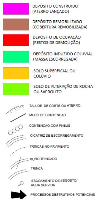
**Figura 6.** Mapa geológico-geotécnico de detalhe (escala original 1:500) da área de risco do Jardim Fortaleza..
