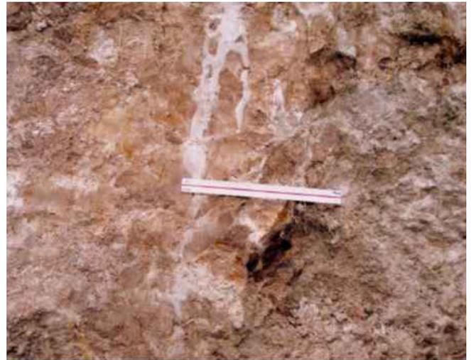
**FOTO 7:** Dique de areia aumentando de espessura para o topo e incluindo fragmentos da rocha encaixante. A escala tem 17 cm de comprimento.
