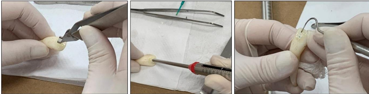
Figura 3: Colagem dos acessórios ortodônticos. Padronização da força de colagem com uso de tensiômetro. Remoção do excesso de resina previamente à polimerização.
