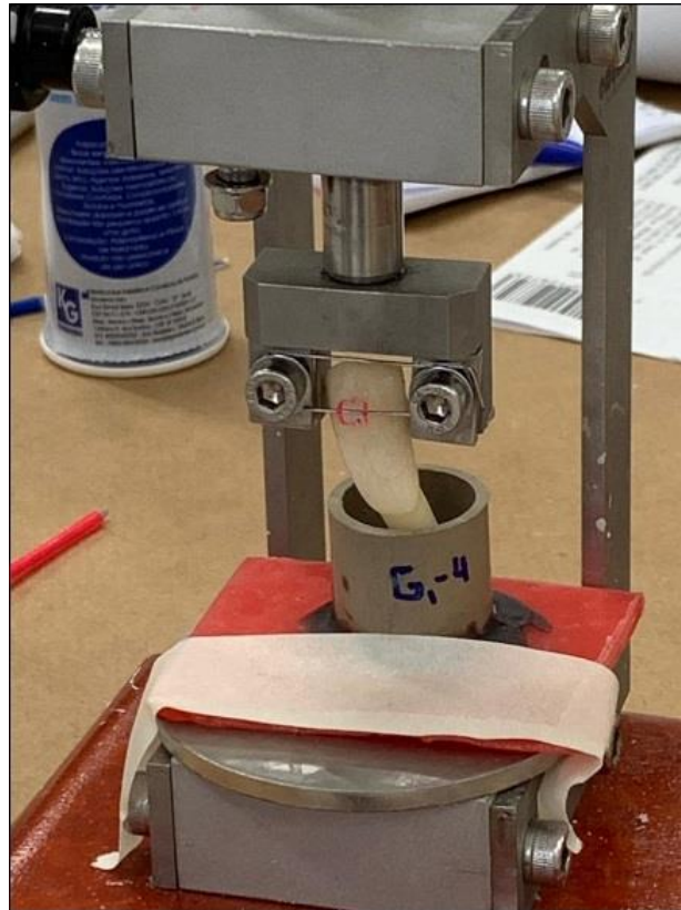
Figura 4: Equipamento para posicionar de forma padronizada a inclusão dos dentes ao tubo de PVC, a fim de manter o braquete perpendicular à máquina para o teste de cisalhamento.
